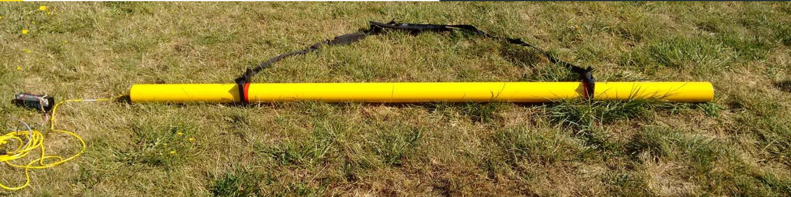
**Le DUALEM 21s est un conductivimètre permettant de mesurer simultanément la conductivité et la susceptibilité magnétique d'un terrain en 4 points de mesures situés à différentes profondeurs.**
