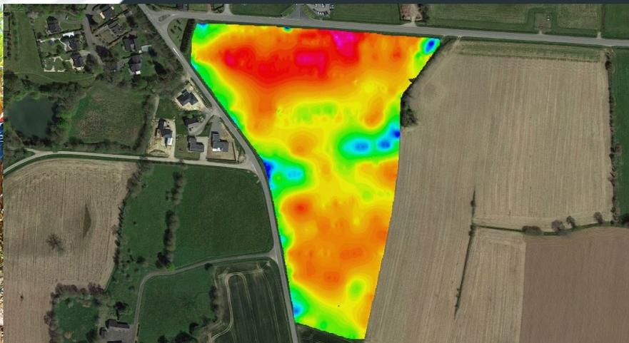
L'EM38-MK2 est un conductivimètre qui permet de mesurer sans contact la conductivité électrique du sol à différentes profondeurs. C'est l'instrument idéal pour localiser les hétérogénéités au sein d'une parcelle agricole.
