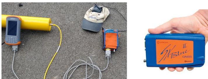
Les GPS SXBlue utilisent une technologie novatrice offrant une précision inférieure à 1 mètre en temps réel et en tout temps. Il ne requiert aucun post-traitement ni de récepteur de signaux de balise lorsque le système de renforcement à couverture étendue SBAS est disponibles. Le SXBlue est le récepteur GPS idéal pour cartographier vos données géophysiques.
