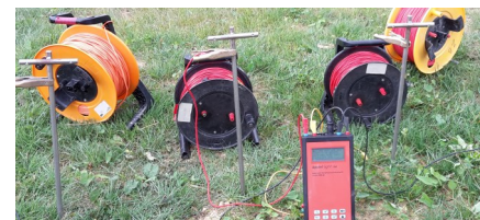
Kit SEV avec inversion via IX1D
