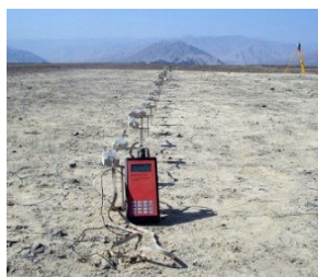
Mesure ERT avec 64 ActELE et inversion avec Res2Dinv 5.0
