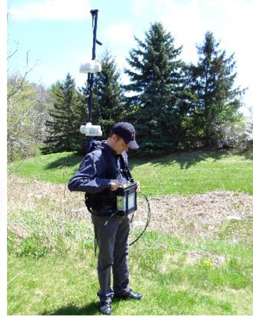
Le **GSM-19** est un magnétomètre à protons champ total. Grâce à sa technologie "overhauser" le **GSM-19** est le magnétomètre/gradimètre de référence pour toutes les applications suivantes : exploration minière, caractérisation du sol (environnement et ingénierie), cartographie de pipeline, détection d'objets explosifs, archéologie, mesure en station magnétique, et prévention en volcanologie...
