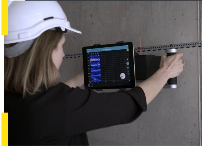
**Le système d'imagerie à écho d'impulsion ultrasonique Pundit PD8050 (UPE) est la solution privilégiée pour l'évaluation de la qualité et de l'uniformité du béton.**
