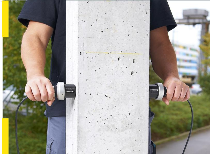
**Le Pundit Lab 200 est un ensemble complet d'évaluation de l'homogénéité du béton grâce à la mesure de vitesse des ondes ultrasoniques.**
