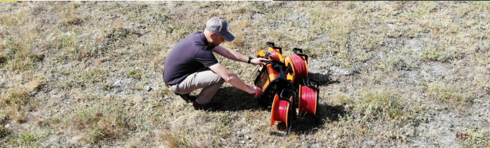
Evolution logique du fameux SAS1000, le **TERRAMETER VES** est un résistivimètre puissant conçu pour les sondages électriques verticaux (SEV). C'est l'instrument idéal pour toutes vos mesures 1D de résistivité ou PP.
